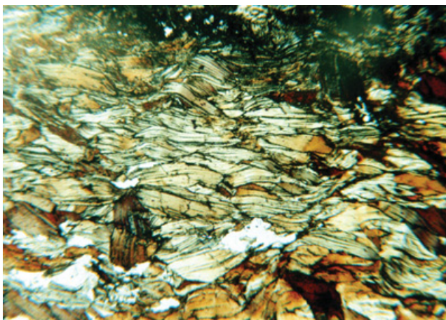
Рис. 3. Деформированный биотитовый кристаллосланец. Скв.20009 Ново-Елховская, инт.3116-3119м. Ув.60х. Николи ||. Зона разуплотнения (деструкции) в кристаллическом фундаменте.
