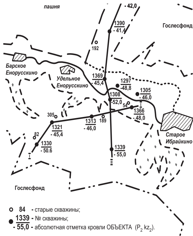
Рис. 3. Схема расположения скважино-кустов на Еноруссинской площади Аксубаевского района. М 1 : 50 000
